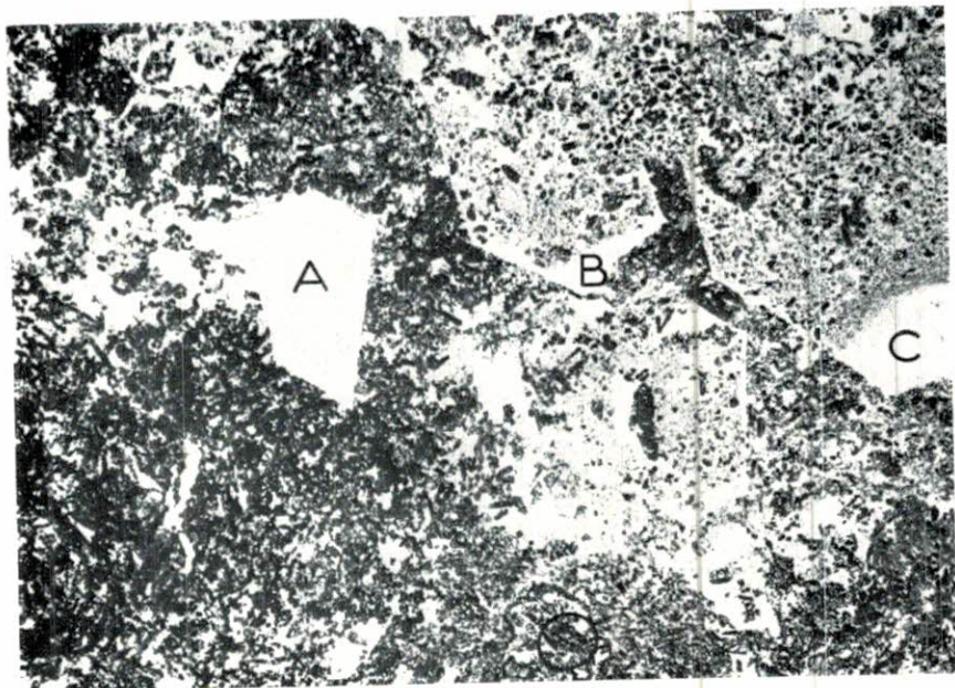
Fig. 3 — Cava di Montaguzzo - Calcare brecciato. Si notano cristalli di gesso (A) che a volte inglobano elementi calcarei a struttura grumosa (B, C). Ingrand. 15.
