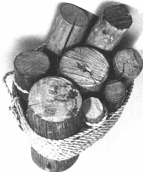
Fig. 21. Fotografia inedita di una serie di «murell» (calibri) per tessere a mano le reti per la pesca in mare, di proprietà dell'autore. I diametri dei calibri fotografati vanno dai mm. 20 ai mm. 50. Collezione Graffagnini.
